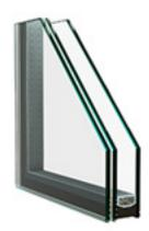
Il vetro fonoisolante Silence-Si è costituito da una lastra accoppiata di sicurezza dotata di speciale pellicola antirumore, la quale incrementa l'elasticità del vetro stesso. Le finestre dotate di questa vetratura raggiungono un valore di isolamento acustico da 42 a 45 dB, quindi un isolamento raddoppiato rispetto a finestre dotate di vetro standard (32 dB).
