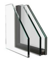
L'isolamento acustico dell'anta accoppiata è ottimo grazie alla sua struttura a sandwich con ampie intercapedini tra le singole lastre, alle guarnizioni multiple ed alla terza lastra di vetro dell'anta accoppiata;  $R_w$ da 41 a 46 dB.
